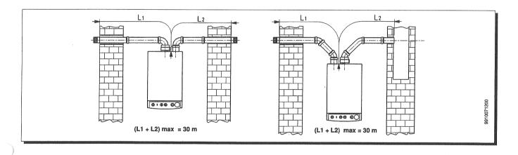
N.B.: Beim Typ C52 dürfen die Endstücke für die Ansaugung der Verbrennungsluft und für den Rauchgasabzug nicht an gegenüberliegenden Wänden des Gebäudes vorgesehen werden.
