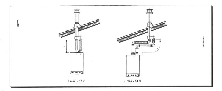
Wichtig: die separate Leitung für den Auslaß des verbrannten Materials muß auf geeignete Weise isoliert werden. Dabei müssen die Stellen, welche die Wände der Wohnung berühren, mit einer geeigneten Isolierung (z.B.Glaswollschicht) versehen werden.
