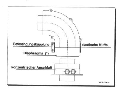
(\*) Das sich im Heizkessel befindliche Diaphragma kann nur dann entfernt werden, wenn die Auslaßleitung länger als 1,5 Meter ist.
