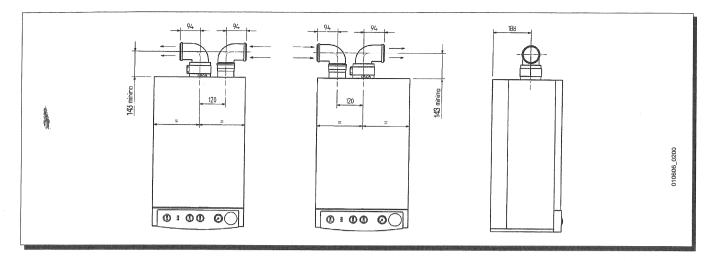
Der Einbau eines  $90^{\circ}$  - Krümmers reduziert die Gesamtlänge der Leitung um 0.5 Meter. Der Einbau eines  $45^{\circ}$  - Krümmers reduziert die Gesamtlänge der Leitung um 0.25 Meter.
